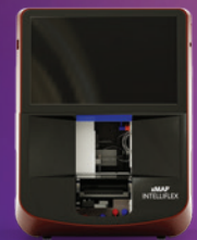
Luminex® Multiplex-Verfahren für bis zu 50 Analyten in einer Probe.
