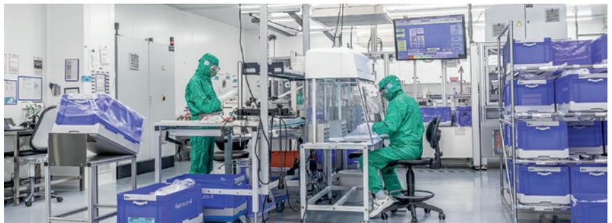
Blick in den ISO7-Reinraum bei RKT: Auf der linken Seite erfolgt die Qualitätsendkontrolle, die manuell durchgeführt wird. Unter der Clean-Air- und UV-Licht-Werkbank auf der rechten Seite werden Stickpacks verarbeitet.
